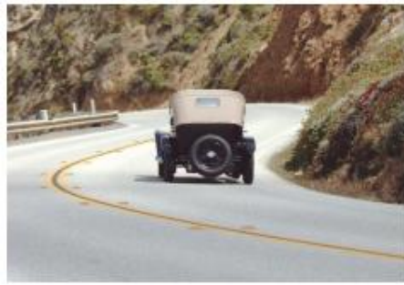
▲圖 汽車在水平路面遇到轉彎時，用摩擦力作為向心力。
