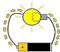
使燈泡亮起來的方法是用電線把燈泡接上乾電池，組成一個閉合電路讓電通過，只要電流順利通過所有元件形成完整的循環，燈泡便會亮起來。
