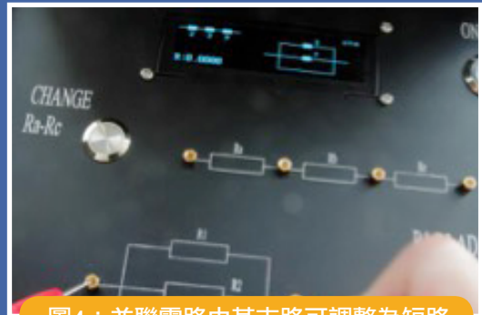
圖4：並聯電路中某支路可調整為短路
