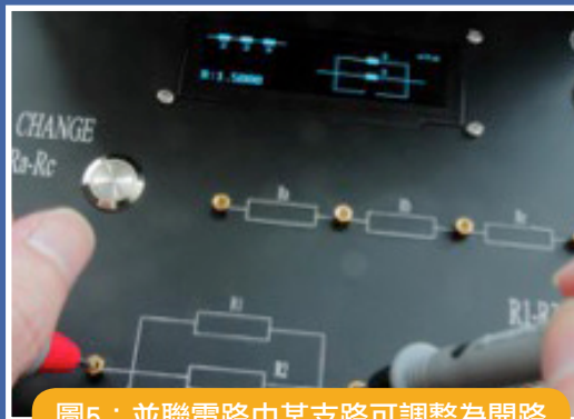
圖5：並聯電路中某支路可調整為開路
