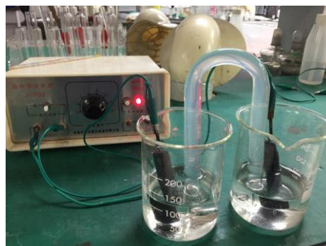
學生模擬電解水機的工作原理
