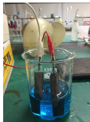
學生模擬電解水機的工作原理
