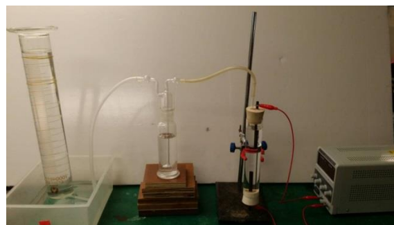
學生自行設計的電解及收集氣體的裝置
