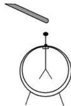
2· 當帶電的物體與驗電器上面的金屬球接觸時，有一部分電荷轉移到驗電器上，與金屬球相連的兩個金屬箔片帶上同種電荷，因相互排斥而張開，物體所帶電荷量越多，電荷轉移的越多，斥力越**大**，張開的角度也
