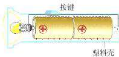
圖 (1) 手電筒內部結構圖
