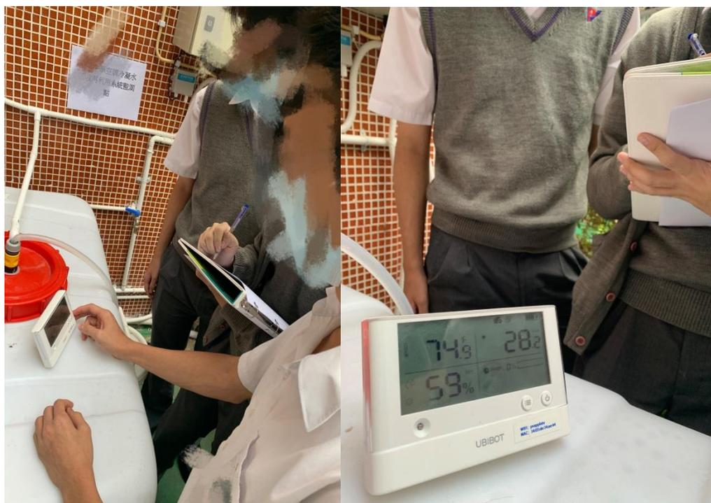
圖 15 學生在空調冷凝水監測點進行溫濕度測量。
