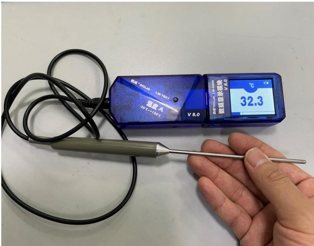
圖 1 教學中介紹溫度傳感器所使用的圖片。
